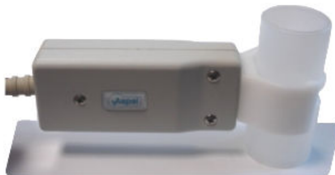
Rys. 13. Pozycja głowicy podczas zerowania.
